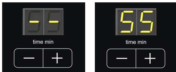
Рис. 12: Настройка времени в непрерывном режиме (слева) или с указанием времени процесса (справа)
